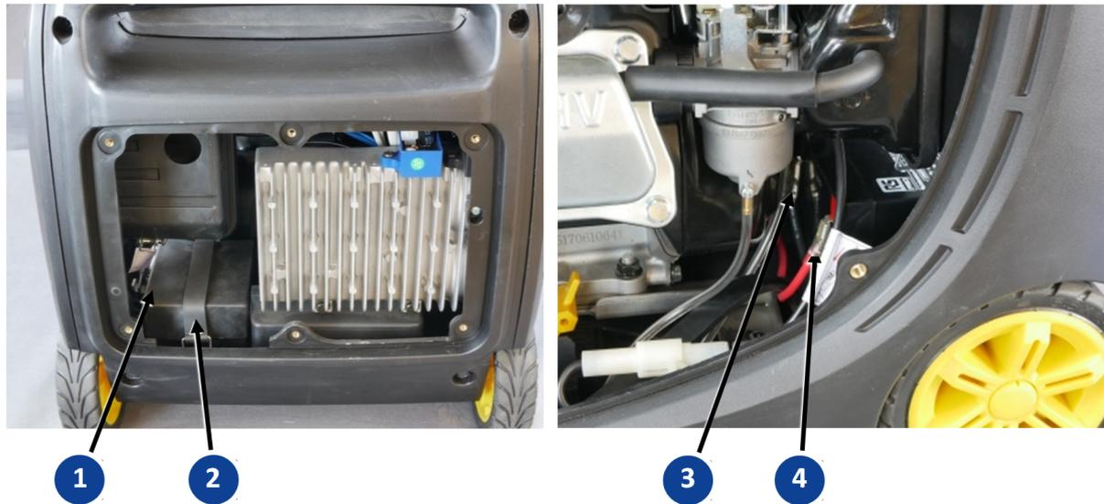
Fig. 9-9 Remplacer la batterie de démarrage
